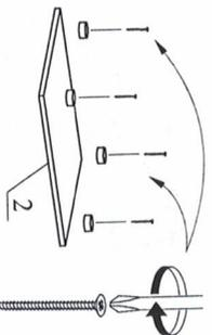
Закрепите опоры по шаблону на детали 2 с помощью саморезов 4x32.
